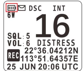
Lorsque la radio est éteinte et en charge, l'icône de la batterie clignote au centre de l'écran.
