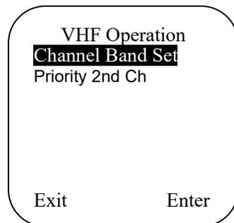
L'option « Channel Band Set » vous permet de sélectionner la bande de canaux souhaitée parmi les trois options suivantes : « USA », « INT » et « CAN ».
